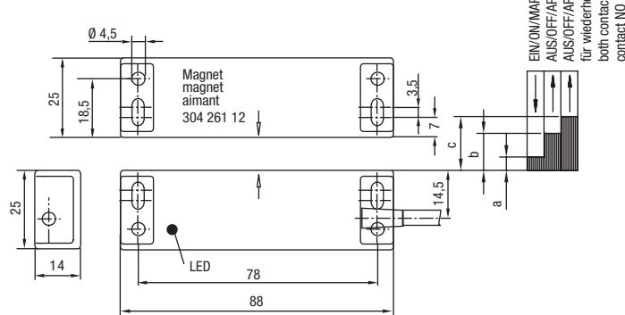
165 270 AOD    mit Rundstecker M8 / with round connector M8 / avec connecteur M8
