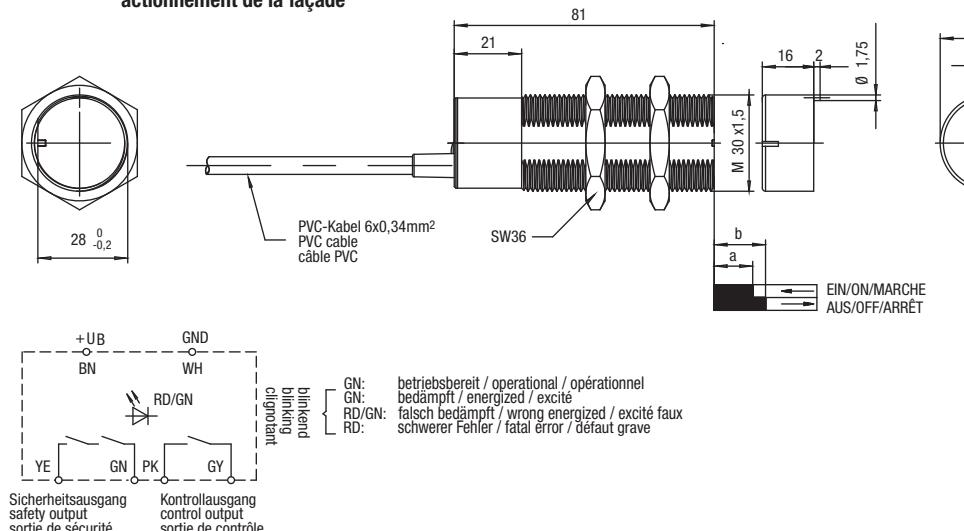
Schaltbilleddarstellung in spannungslosem Zustand. Sensor nicht betätigt.
