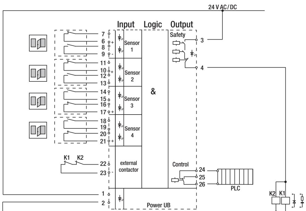
1) Maximal 32 Sensoren über externe Verknüpfung. Wir empfehlen die Verwendung unserer Schnittstellen 363 098 (S. 160-161).
