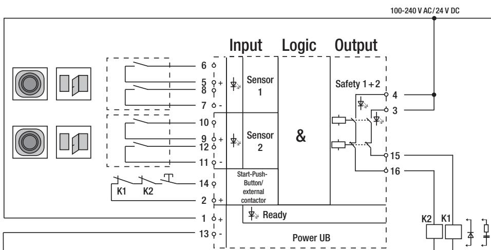
1) Maximal 16 Sensoren über externe Verknüpfung. Wir empfehlen für die Sensoren die Verwendung unserer Schnittstellen 363 V99 / 363 V97 (S. 72-73).
