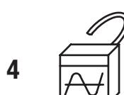
geschützt gegen Eindringen von festen Fremdkörpern  $\geq 1,0$  mm Durchmesser (z.B. Draht)
