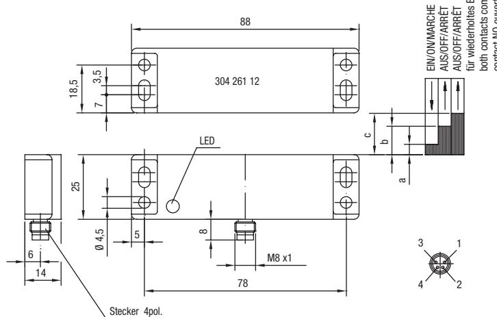
Achtung: bei Ausschöpfung aller Versatztoleranzen und des gesamten Temperaturbereichs ist eine Verkürzung des Schaltabstandes möglich.
