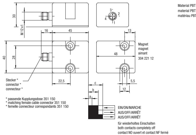
Achtung: bei Ausschöpfung aller Versatztoleranzen und des gesamten Temperaturbereichs ist eine Verkürzung des Schaltabstandes möglich.
