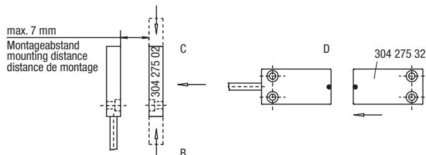
Versatz Sensor-Magnet max. 3 mm
