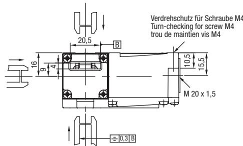
Nach Lösen der Befestigungsschrauben kann der Betätigungskopf in die gewünschte Anfahrrichtung umgestellt werden.
