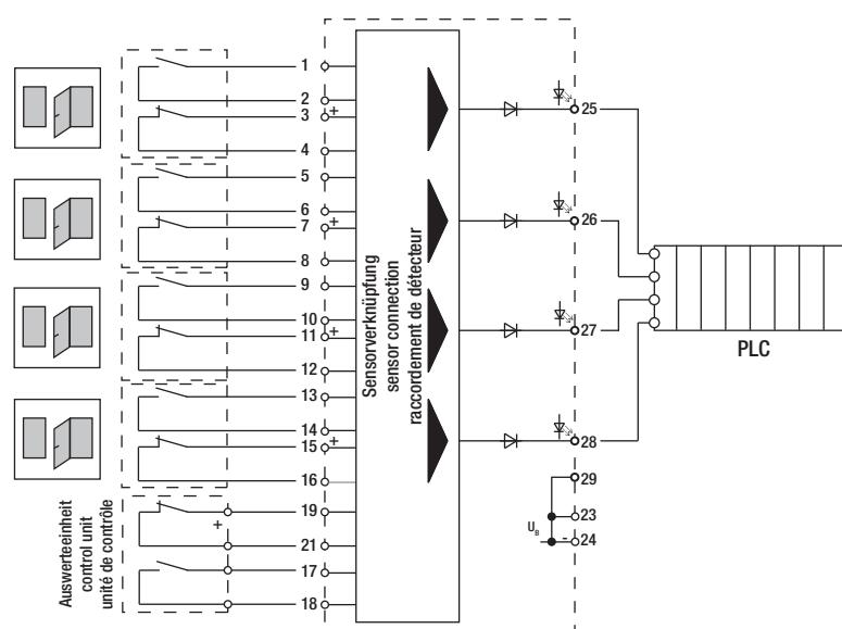
Es besteht die Anschlussmöglichkeit von max. 4 Sensoren. Bei Anschluss von weniger als 4 Sensoren müssen die freien Klemmen der Schließerkontakte überbrückt werden. Bei Verknüpfung von mehr als 4 Sensoren siehe Schaltbilddarstellung nächste Seite.
