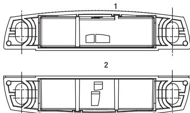
Magnetsystem um 90° verdreht montierbar.
