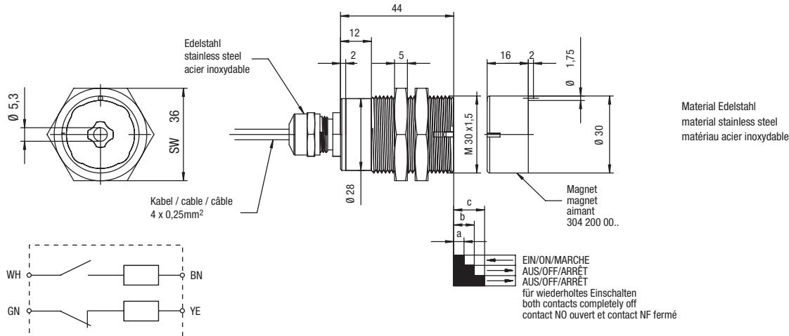
**171 271 V mit Kabel / with cable / avec câble**
