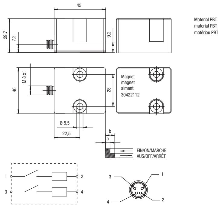
Achtung: bei Ausschöpfung aller Versatztoleranzen und des gesamten Temperaturbereichs ist eine Verkürzung des Schaltabstandes möglich.
