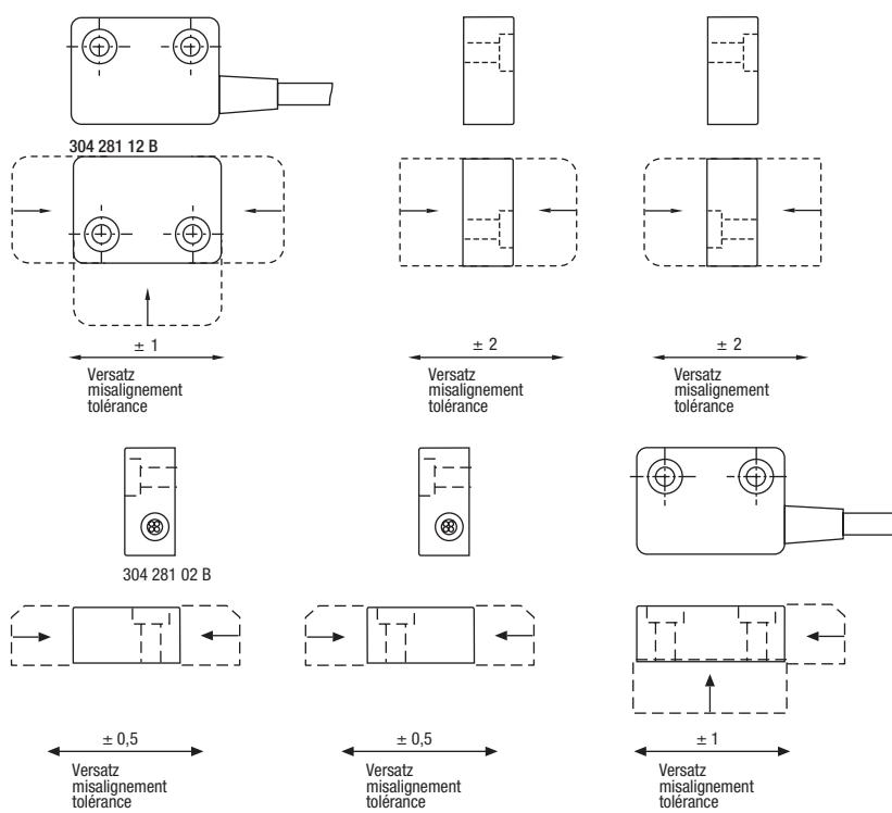
**153 V62 S..** für Sensoren/for sensors/pour détecteurs 153 V62 S..
