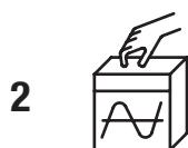
geschützt gegen Eindringen von festen Fremdkörpern  $\geq 12,5$  mm Durchmesser (z.B. Finger)
