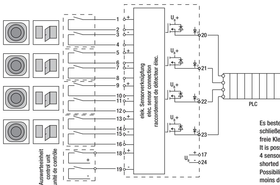
Es besteht die Möglichkeit, max. 4 Sensoren anzuschließen. Bei Anschluss von weniger als 4 Sensoren freie Klemmen der Schließerkette überbrücken.
