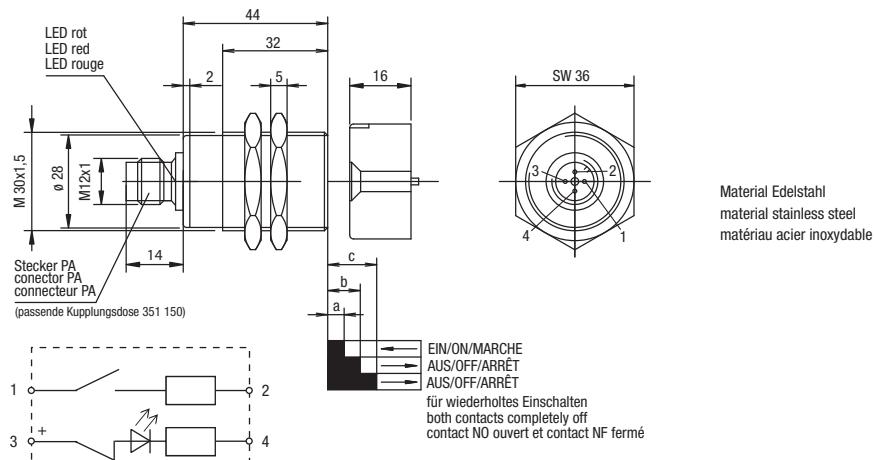
Achtung: bei Ausschöpfung aller Versatztoleranzen und des gesamten Temperaturbereichs ist eine Verkürzung des Schaltabstandes möglich.
