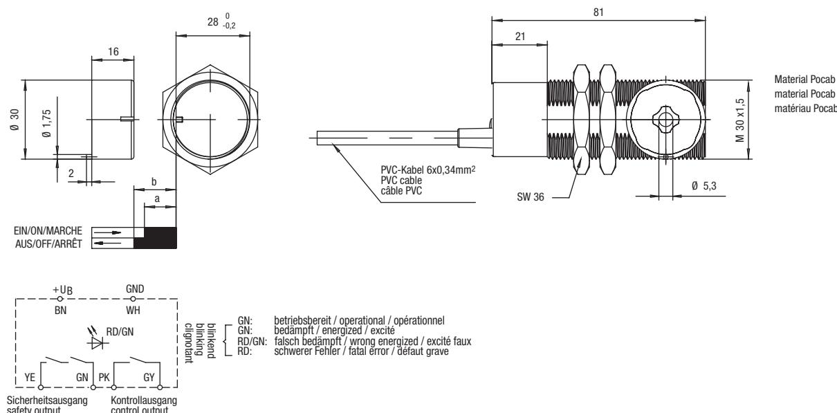
Schaltbilleddarstellung in spannungslosem Zustand. Sensor nicht betätigt.
