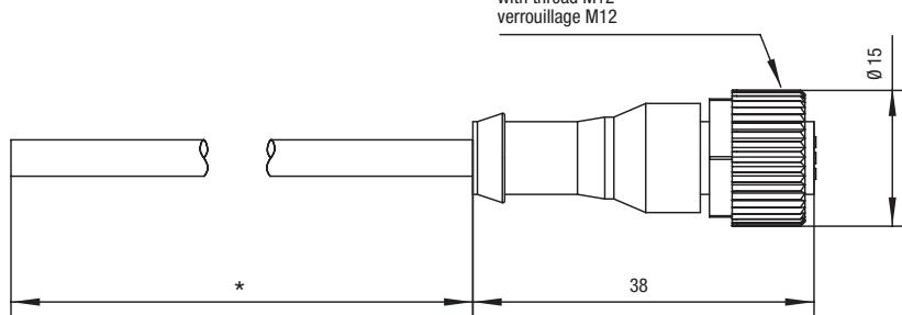
Passt auf alle Schalter mit 4-poligen Rundsteckern mit Gewinde M12.
