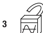
geschützt gegen Eindringen von festen Fremdkörpern  $\geq 2,5$  mm Durchmesser (z.B. Werkzeug)
