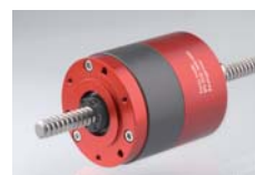
BPS-2532-SR4 Schrittmotor mit 10 Nm, 300 mm Spindel Ø 12 mm / Steigung 4 mm
