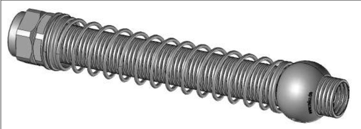
Die Ganzmetall-Anschlussarmatur MSGRM-17...K wird mit der Knickschutzfeder FSMK-17-180 verbunden. Das zu schützende Wellrohr wird mit einem Protektor ausgestattet, der die Feder auf die nötige Vorspannung bringt. Die Lösung verhindert ein Abknicken des Wellrohres und ein unterschreiten des Biegeradius. Auch bei hochdynamischen Anwendungen geeignet.
