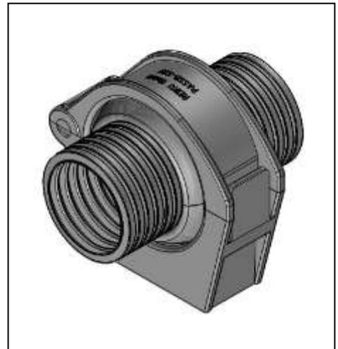
Kugelgelenke entlasten das Wellrohr gegenüber Knick- und Torsionsbewegungen. Ein Kugelgelenk in der NW42 besteht aus dem Kugelprotektor PAKPB-42 und einer 52er Spannschelle, wie PASSB-52M oder PASSB-52K.
