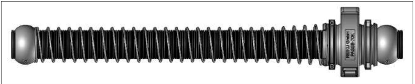
Die Federkugel wird mit der montierten Feder in die 70er Spannschelle eingelegt. Als Anschlag für die Feder wird ein Protektor der NW48 auf das Wellrohr montiert. Dieses Federrückholssystem wird im Set mit einer mittleren Federausführung angeboten (s.u.). Weitere Informationen zu Federn erhalten Sie im Datenblatt „Feder-Spring“. Andere Kombinationen sind auf Anfrage möglich.
