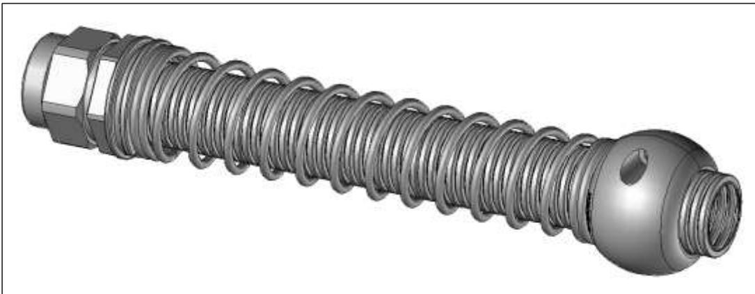
Die Ganzmetall-Anschlussarmatur MSGRM-23...K wird mit der Knickschutzfeder FSMK-23-180 verbunden. Das zu schützende Wellrohr wird mit einem Protektor ausgestattet, der die Feder auf die nötige Vorspannung bringt. Die Lösung verhindert ein Abknicken des Wellrohres und ein unterschreiten des Biegeradius. Auch bei hochdynamischen Anwendungen geeignet.
