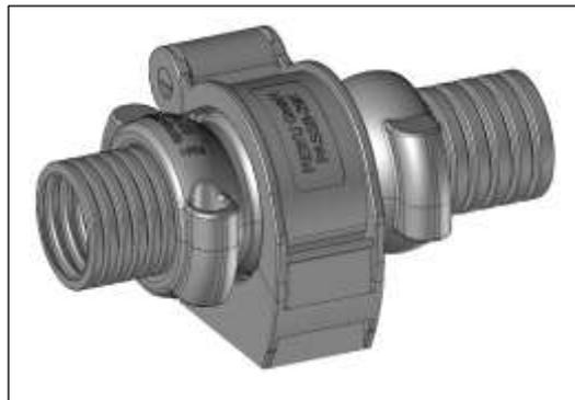
PAVGB-23 wird in die 29er Spannschelle eingesetzt und dient der Beseitigung von Torsionsmomenten. Es ist um 360° drehbar und kippbar um 11°. Das Verbindungsgelenk kann zwei Wellrohre der NW23 miteinander verbinden oder ein Wellrohr und einen Kabelstern der NW23 aufnehmen.
