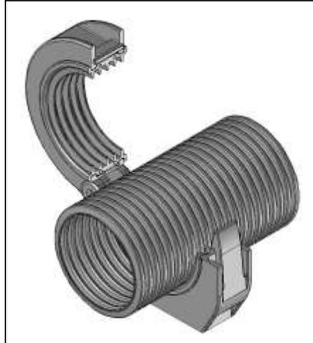
Die zweiteiligen Backen werden um das Wellrohr herum montiert und in die Spannschelle eingelegt (siehe untere Zeichnung). PAKMB-90 dient zum Lagern der Wellrohre in der Spannschelle oder kombiniert verschiedene Wellrohrqualitäten der NW95.
