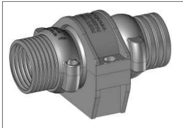
PAVGB-36 wird in die 36er Spansschelle eingesetzt und dient der Beseitigung von Torsionsmomenten. Es ist um 360° drehbar und kippbar um 11°. Das Verbindungsgelenk kann zwei Wellrohre der NW36 miteinander Verbinden oder ein Wellrohr und einen Kabelstern der NW36.
