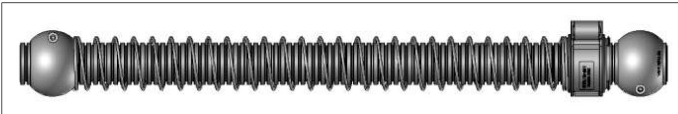
Der Federhalter wird mit der montierten Feder in die 29er Spannschelle eingelegt. Als Anschlag für die Feder wird ein Protektor der NW29 auf das Wellrohr montiert. Es kann nach Bedarf die Version aus der Nennweite 36 (POFHB-36/36) verwendet werden, um mehr Spiel zwischen Wellrohr und Gleitbacke zu erhalten. Hier muss dann die 36er Spannschelle verwendet werden.
