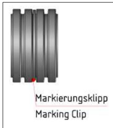
Die opaken (N) oder roten (R) Markierungsklippse kennzeichnen die Montagestellen auf dem Wellrohr für das REIKU-Zubehör. Sie werden im Wellental des Fein-, Mittel- oder Grob-Profils gehalten. Je nach Anwendung können die Markierungsklippse nach der Zubehörmontage im Wellental versenkt bleiben.
