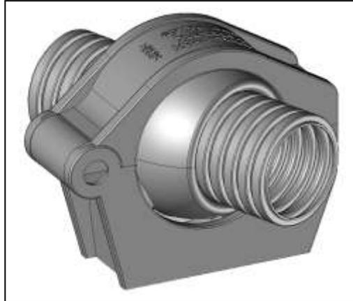
Kugelgelenke entlasten das Wellrohr gegenüber Knick- und Torsionsbewegungen. Ein Kugelgelenk in der NW29 besteht aus dem Kugelprotektor PAKPB-29 und einer 36er Spannschelle, wie PASSB-36S oder PASSB-36K. Der Kugelprotektor ist um 360° drehbar und kippar um 20°.
