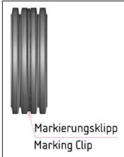
Die opaken (N) oder roten (R) Markierungsklippse der NW52 sind kompatibel zum Wellrohr der NW68 und kennzeichnen die Montagestellen auf dem Wellrohr für das REIKU-Zubehör. Sie werden im Wellental des Fein-, Mittel- oder Grob-Profils gehalten. Je nach Anwendung können die Markierungsklippse nach der Zubehörmontage im Wellental versenkt bleiben.
