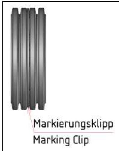
Die opaken (N) oder roten (R) Markierungsklippse kennzeichnen die Montagestellen auf dem Wellrohr für das REIKU-Zubehör. Sie werden im Wellental des Fein-, Mittel- oder Grob-Profils gehalten. Je nach Anwendung können die Markierungsklippse nach der Zubehörmontage im Wellental versenkt bleiben.
