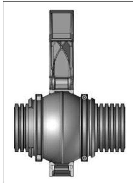
Die Federkugel wird in die 90er Spannschelle mit Metall- oder Kunststoffverschluss (POSSB-90M / POSSB-90K) eingelegt. Sie ist um 360° drehbar, kippbar in einem Winkel um 12° sowie als Gleitbacke verwendbar. Die Federaufnahme ist von beiden Seiten möglich.
