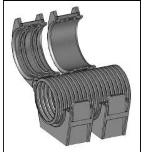
Die zweiteiligen Backen werden um das Wellrohr herum montiert und in die Spannschelle eingelegt (siehe rechte Zeichnung). PAMBB-52 fixiert das Wellrohr und kann zum Kombinieren von verschiedenen Wellrohrqualitäten oder eines Wellrohrs mit einem Kabelstern NW52 verwendet werden. Bei PAGLB-52 kann das Wellrohr hindurchgleiten.
