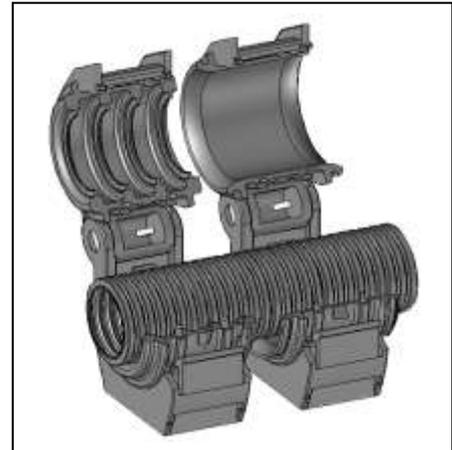
Die zweiteiligen Backen werden um das Wellrohr herum montiert und in die Spannschelle NW29 eingelegt (siehe rechte Zeichnung). Der Federhalter wird als Gleitbacke verwendet. Die Spannschelle gibt es in der Ausführung mit Kunststoffverschluss, PASSB-29K.
