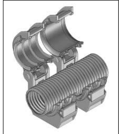
Die zweiteiligen Backen werden um das Wellrohr herum montiert und in die Spannschelle PASSB-29K eingelegt (siehe rechte Zeichnung). Die Spannschelle gibt es in der Ausführung mit Kunststoffverschluss. Der Federhalter wird als Gleitbacke verwendet. Um mehr Spiel zwischen Wellrohr und Gleitbacke zu erhalten, kann nach Bedarf die Version aus der Nennweite 36 (POFHB-36/36) verwendet werden. Hier muss dann die 36er Spannschelle, wie PASSB-36K verwendet werden.
