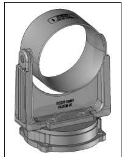
Der Zusammenbau ermöglicht Bewegungsfreiheit für hochflexible Wellrohre. Mit oder ohne Drehflansch verwendbar. Ohne Drehflansch nur kippbar ansonsten drehbar. Beispiel ist mit Drehflansch, siehe rechts außen.
