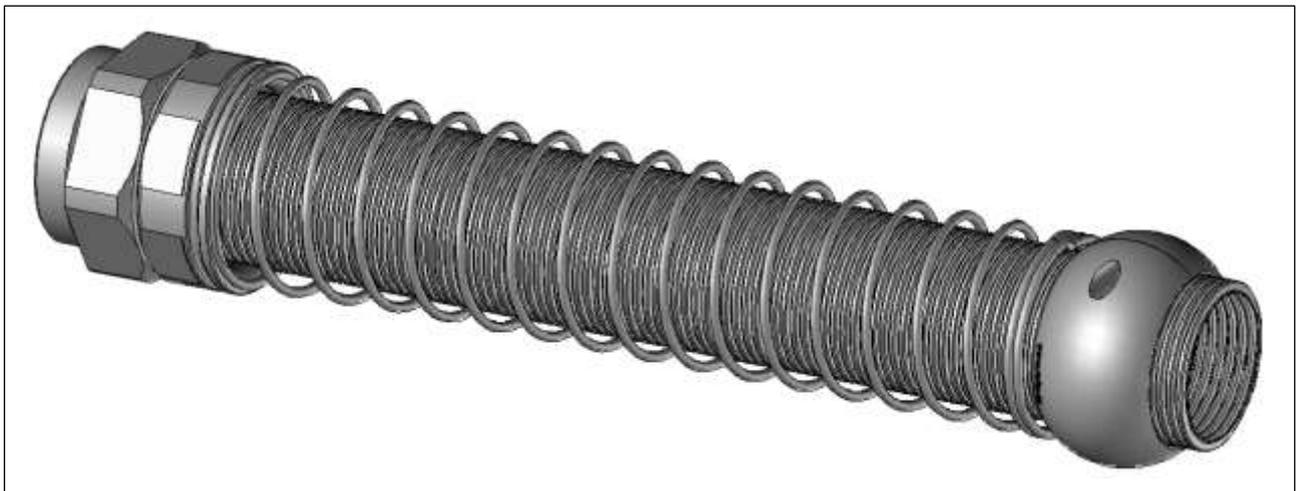
Die Ganzmetall-Anschlussarmatur MSGRM-48...K wird mit der Knickschutzfeder FSMK-48-280 verbunden. Das zu schützende Wellrohr wird mit einem Protektor ausgestattet, der die Feder auf die nötige Vorspannung bringt. Die Lösung verhindert ein Abknicken des Wellrohres und ein unterschreiten des Biegeradius. Auch bei hochdynamischen Anwendungen geeignet.
