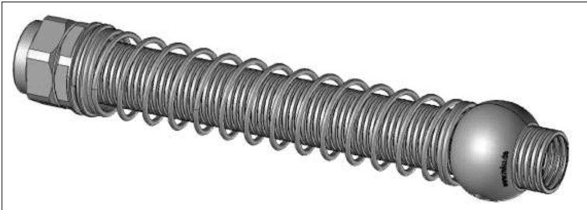
Die Ganzmetall-Anschlussarmatur MSGRM-29...K wird mit der Knickschutzfeder FSMK-29-220 verbunden. Das zu schützende Wellrohr wird mit einem Protektor ausgestattet, der die Feder auf die nötige Vorspannung bringt. Die Lösung verhindert ein Abknicken des Wellrohres und ein unterschreiten des Biegeradius. Auch bei hochdynamischen Anwendungen geeignet.
