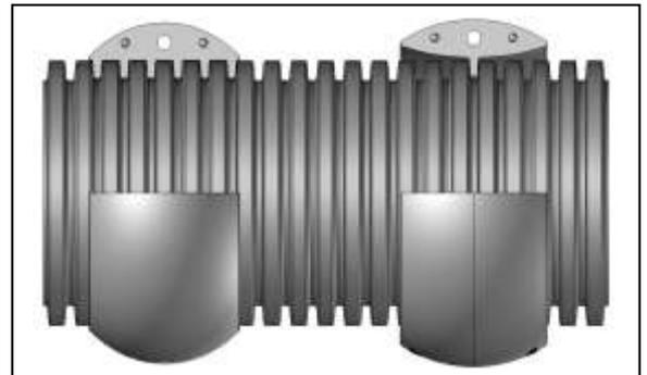
Protektoren als Stoß- und Abriebschutz für Wellrohre mit G-Profil der NW70. PAPRB-70 ist ein Standard-Protektor, der auch zur Kombination oder zur Reparatur von Wellrohren geeignet ist. PADPB-70 dreht sich im Wellental um das Wellrohr. Beim Kombi-Protektor-System werden die Protektoren mittels des Verbindungselementes VAKEM verbunden, um Wellrohre parallel zu führen. Auch die Kombination mit unterschiedlichen Nennweiten ist möglich. Mit Schraubverschluss.
