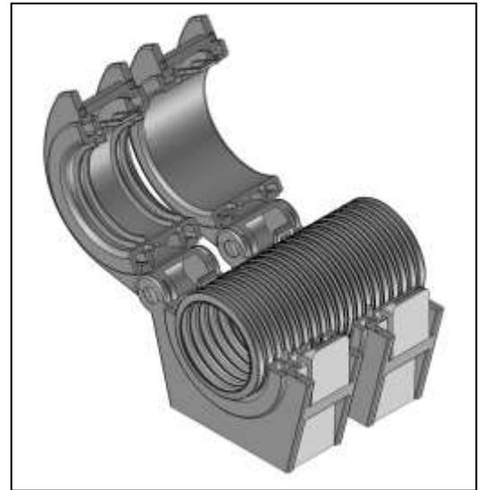
Die zweiteiligen Backen werden um das Wellrohr herum montiert und in die Spannschelle NW52 eingelegt (siehe untere Zeichnung). PAMBB-42 fixiert das Wellrohr und kann zum Kombinieren von verschiedenen Wellrohrqualitäten oder ein Wellrohr mit einem Kabelstern NW42 verwendet werden. Bei PAGLB-48 kann das Wellrohr hindurchgleiten.
