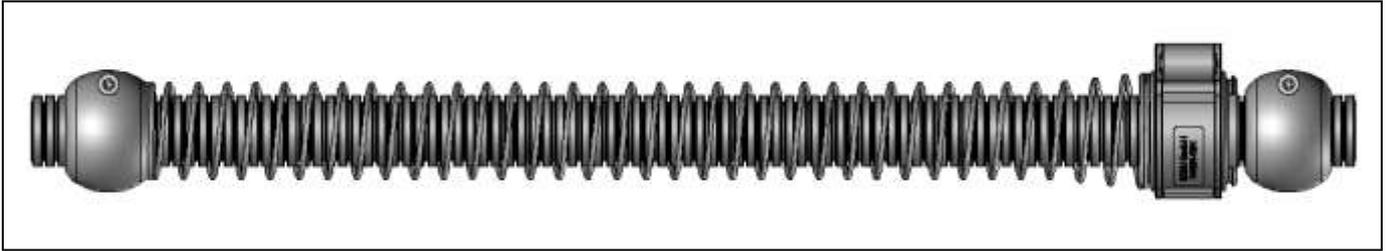
Der Federhalter wird mit der montierten Feder in die 29er Spannschelle eingelegt. Als Anschlag für die Feder wird der Protektor der NW23 auf das Wellrohr montiert.
