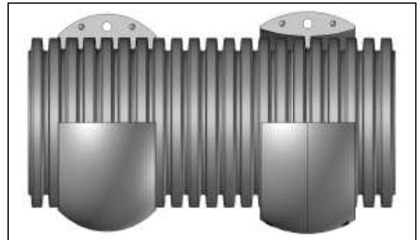
Protektoren als Stoß- und Abriebschutz für Wellrohre mit G-Profil der NW68. PAPRB-68 ist ein Standard-Protector, der auch zur Kombination oder zur Reparatur von Wellrohren geeignet ist. PADPB-68 dreht sich im Wellental um das Wellrohr. Beim Kombi-Protector-System werden die Protektoren mittels des Verbindungselementes VAKEM verbunden, um Wellrohre parallel zu führen. Auch die Kombination mit unterschiedlichen Nennweiten ist möglich. Mit Schraubverschluss.
