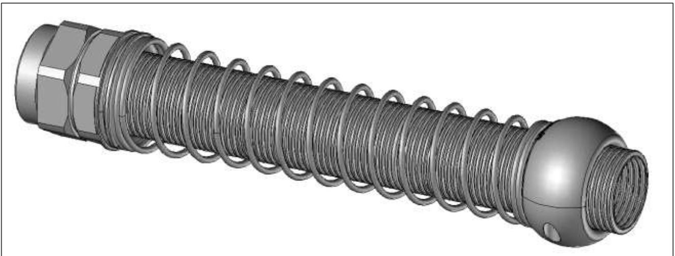
Die Ganzmetall-Anschlussarmatur MSGRM-36...K wird mit der Knickschutzfeder FSMK-36-230 verbunden. Das zu schützende Wellrohr wird mit einem Protektor ausgestattet, der die Feder auf die nötige Vorspannung bringt. Die Lösung verhindert ein Abknicken des Wellrohres und ein unterschreiten des Biegeradius. Auch bei hochdynamischen Anwendungen geeignet.
