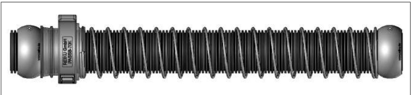
Der Federhalter wird mit der montierten Feder in die 70er Spannschelle eingelegt. Als Anschlag für die Feder wird ein Protaktor der NW70 auf das Wellrohr montiert.
