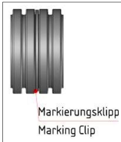
Die opaken (N) oder roten (R) Markierungsklippse kennzeichnen die Montagestellen auf dem Wellrohr für das REIKU-Zubehör. Sie werden im Wellental des Fein-, Mittel- oder Grob-Profils gehalten. Je nach Anwendung können die Markierungsklippse nach der Zubehörmontage im Wellental versenkt bleiben.
