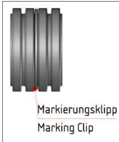
Die opaken (N) oder roten (R) Markierungsklippse der NW42 sind kompatibel zum Wellrohr der NW48 und kennzeichnen die Montagestellen auf dem Wellrohr für das REIKU-Zubehör. Sie werden im Wellental des Fein-, Mittel- oder Grob-Profiles gehalten. Je nach Anwendung können die Markierungsklippse nach der Zubehörmontage im Wellental versenkt bleiben.
